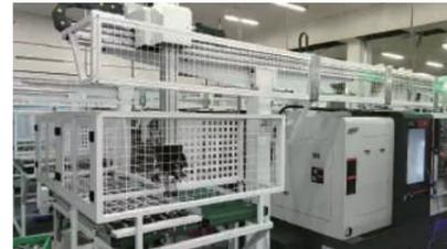
车床取放一对二桁架(双工序加工)
