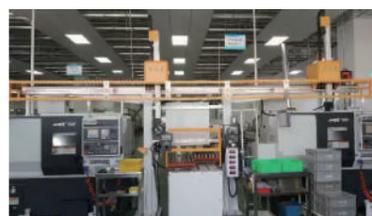
车床取放双通道二对二桁架(共用料盘轴)
