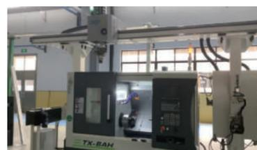
车床取放双通道二对三桁架(输送带)
