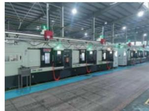
车床取放一对多桁架(产线整合)
