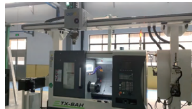
車床取放 雙通道二對三桁架 (輸送帶)
