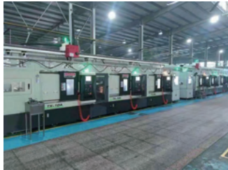
車床取放 一對多桁架 (產線整合)
