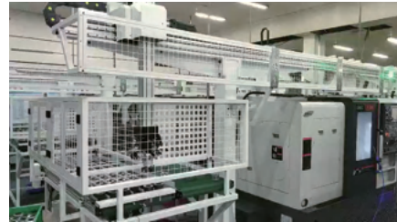
車床取放 一對二桁架 (雙工序加工)
