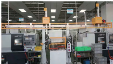
車床取放 雙通道二對二桁架 (共用料盤軸)
